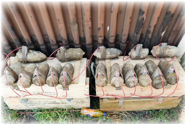
Zur Sprengung vorbereitet
